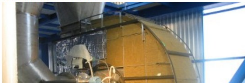
„Акким Кимия Санайи” А.Ш – завод в Ялова Звукоизолация на SPC съоръжения
